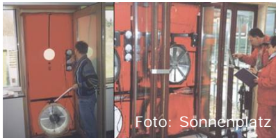
Luftdichtemessung in der Praxis
