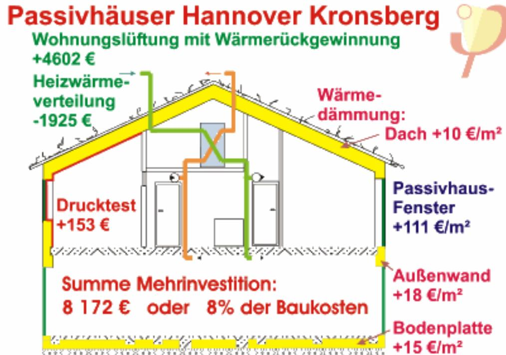
**Abb.2: Die zusätzlichen Kosten des verbesserten Wärmeschutzes und der Gebäudetechnik bei jedem einzelnen Bauelement.** Das Passivhauskonzept zeichnet sich gerade dadurch aus, dass die ohnehin erforderlichen Bauteile so optimal wie möglich verbessert werden.
